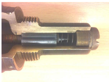
Figuur 1 Opengewerkt Engels pistool no30 impact ontsteker; de slagpin wordt opgehouden door een ophoudveer die is ingeklemd tussen de slagpin (links) en (ingeschroefde) veerhouder aan het uiteinde van de ontsteker (rechts).
