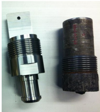
Figuur 24 Dummy ontsteker (links) en de AN-M103 ontsteker (rechts).
