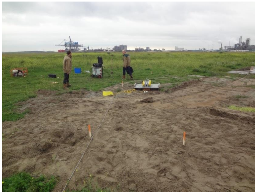
Figuur 32 Trillingsmeting Kop van de Beer; de excitator staat op een afstand van 5 m en onder een hoek van 90° ten opzichte van de lijn met versnellingsopnemers in de bom en in de grond (gemarkeerd met de oranje/witte paaltjes op de voorgrond).
