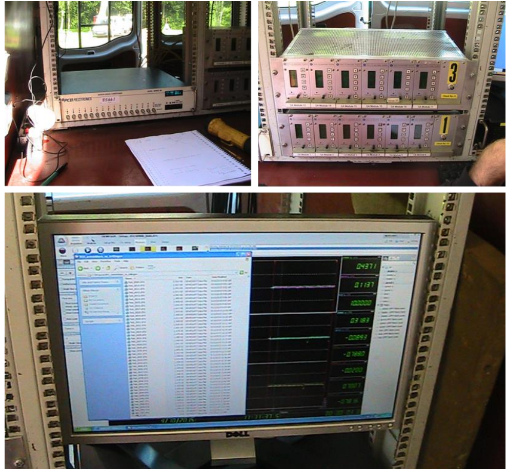
Figuur 33 Data acquisitie systeem: DAQ voor de ICP en Sundstrand sensoren (boven), computer waarmee de bemonsterde versnellingsignalen worden gemonitord (onder).
