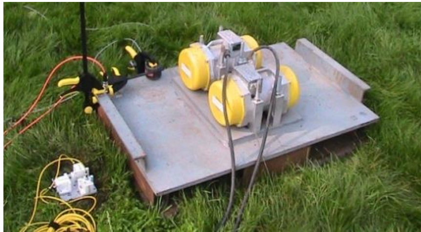
Figuur 26 Excitator van de gemeente Rotterdam met versnellingsopnemers op maaiveld links van de trilplaat.
