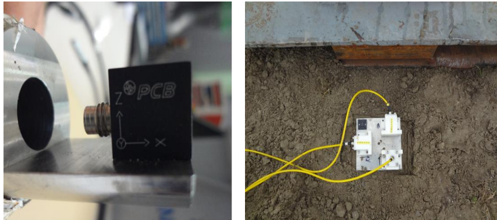
Figuur 28 Versnellingsopnemers toegepast voor de metingen: 3-component ICP opnemer op de dummy ontsteker (links) en drie Sundstrand opnemers met bekabeling nabij de excitator (rechts).
