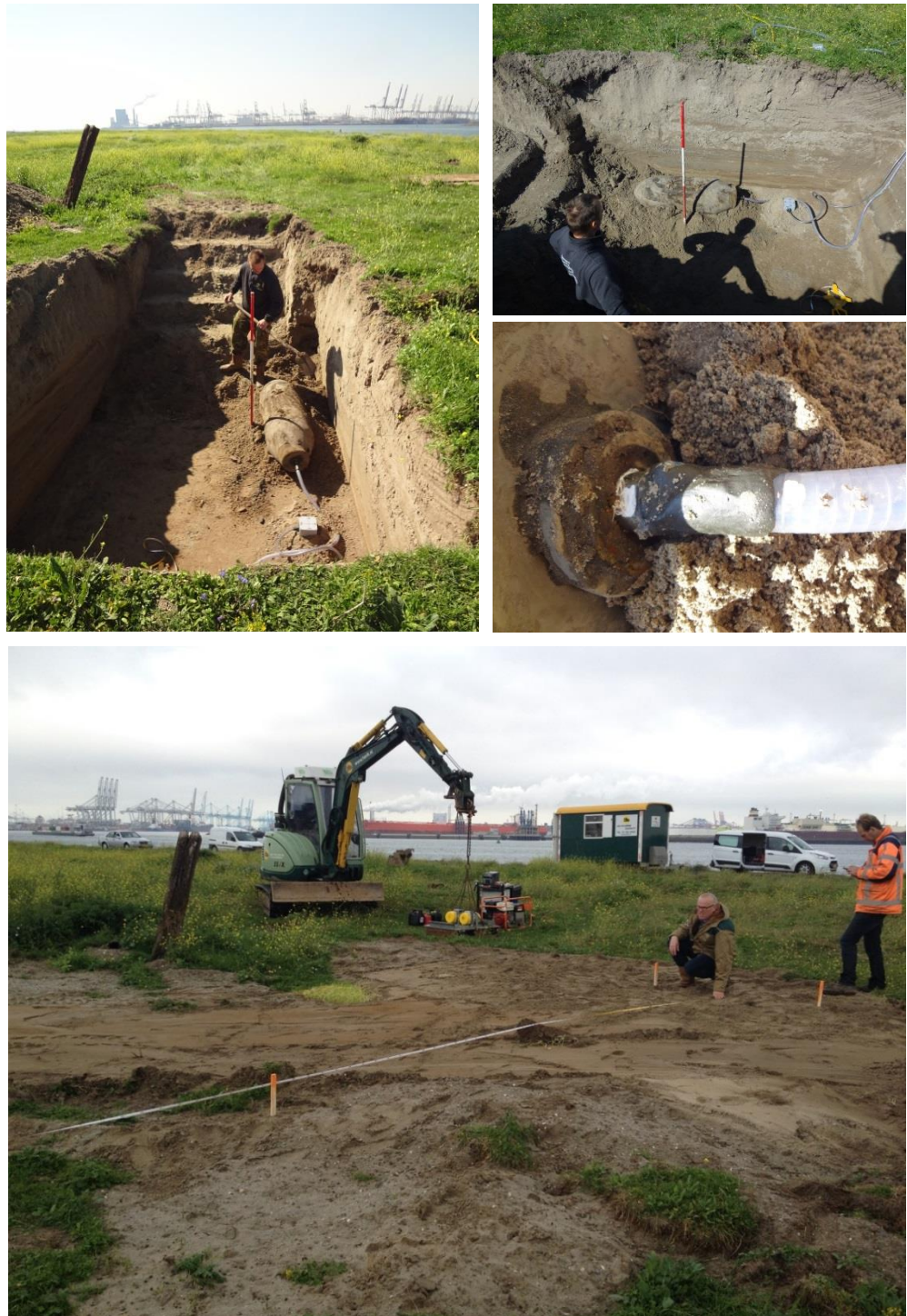
Figuur 22 Locatie Kop van de Beer: horizontale plaatsing bom en versnellingsopnemers in behuizing naast het bomlichaam (links- en rechtsboven); waterdichte sealing met kneedbaar rubber op de verbinding tussen bedrading in pvc leiding en het bomlichaam (rechtsmidden); plaatsbepaling en aanvoer van de excitator met bijbehorend aggregaat en aansturing (onder).
