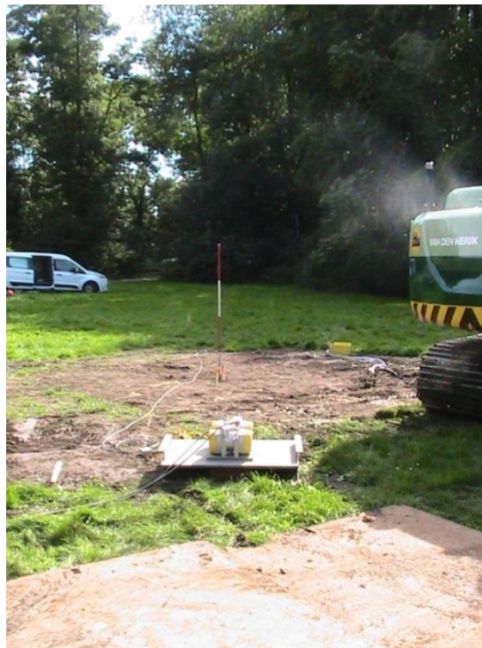
Figuur 31 Trillingsmeting Zestienhoven; de excitator staat op een afstand van 5 m en in lijn met versnellingsopnemers in de bom en in de grond (gemarkeerd met de oranje/witte paaltjes op de achtergrond).
