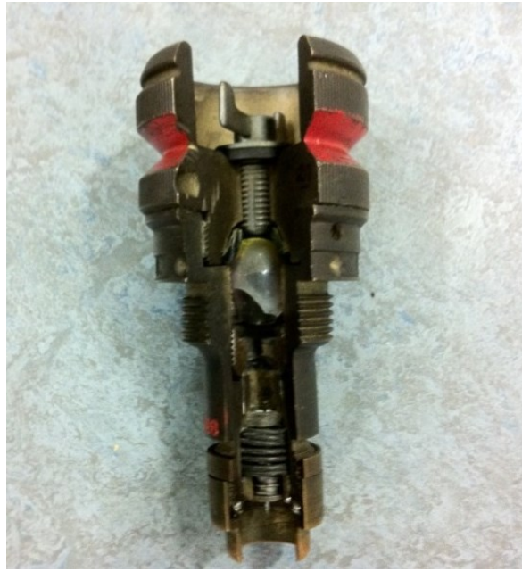
Figuur 5 Opengewerkte Engelse pistool 37 ontsteker met chemisch lange vertraging en anti-demonteer inrichting met een gebroken glas ampul en intacte celluloid disk.
