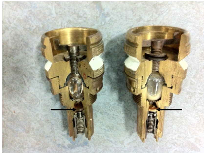
Figuur 17 Opengewerkte Engelse pistool 37 ontstekers met chemisch lange vertraging met een verschil in verkleuring van de celluloid disk (aangeduid met een zwarte pijl).
