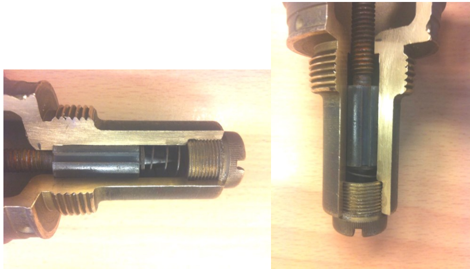
Figuur 9 Opengewerkt model van pistool no30 met verschil in indrukking van de veer afhankelijk van oriëntatie. In de foto links is de no30 in horizontale positie en in de foto rechts in verticale positie.
